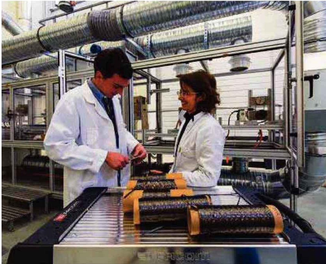
Ci-dessus, un pilote de pré-imprégnation de matériaux thermoplastiques à haute performance renforcés en fibre de carbone. Photo Patrick Dumas pour IRT Saint Exupéry
